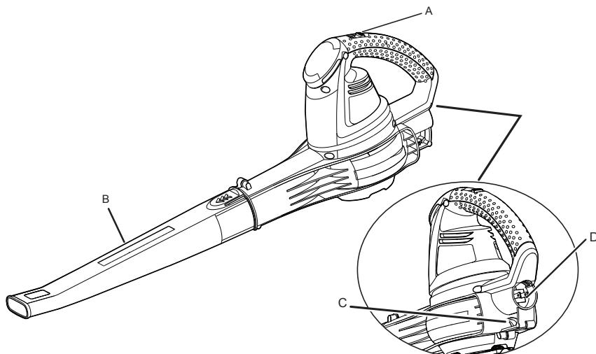
A — Interruptor de Encendido/Apagado
