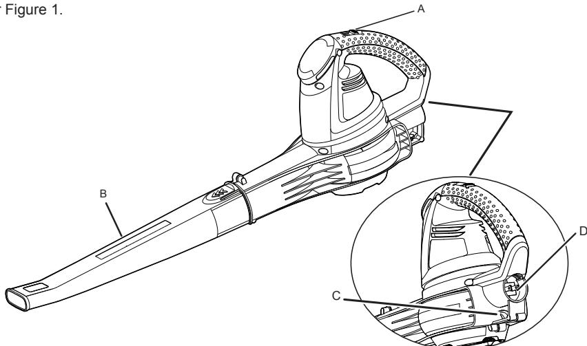
A — Interrupteur marche/arrêt (ON/OFF)
