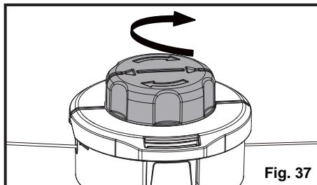
**NOTA:** Limpie siempre la tapa del cabezal de la bordeadora y su carcasa antes de reensamblar el cabezal.
