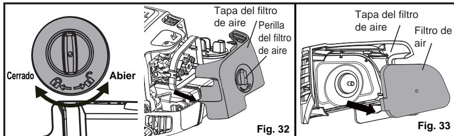
**NOTA:** Inspeccione el filtro para ver si hay daños, reemplácelo si es necesario.
